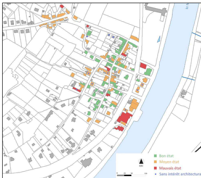
Évaluation de l'état des façades du centre du village (source: relevés de terrain)
